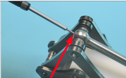
Mit Madenschrauben sichern
