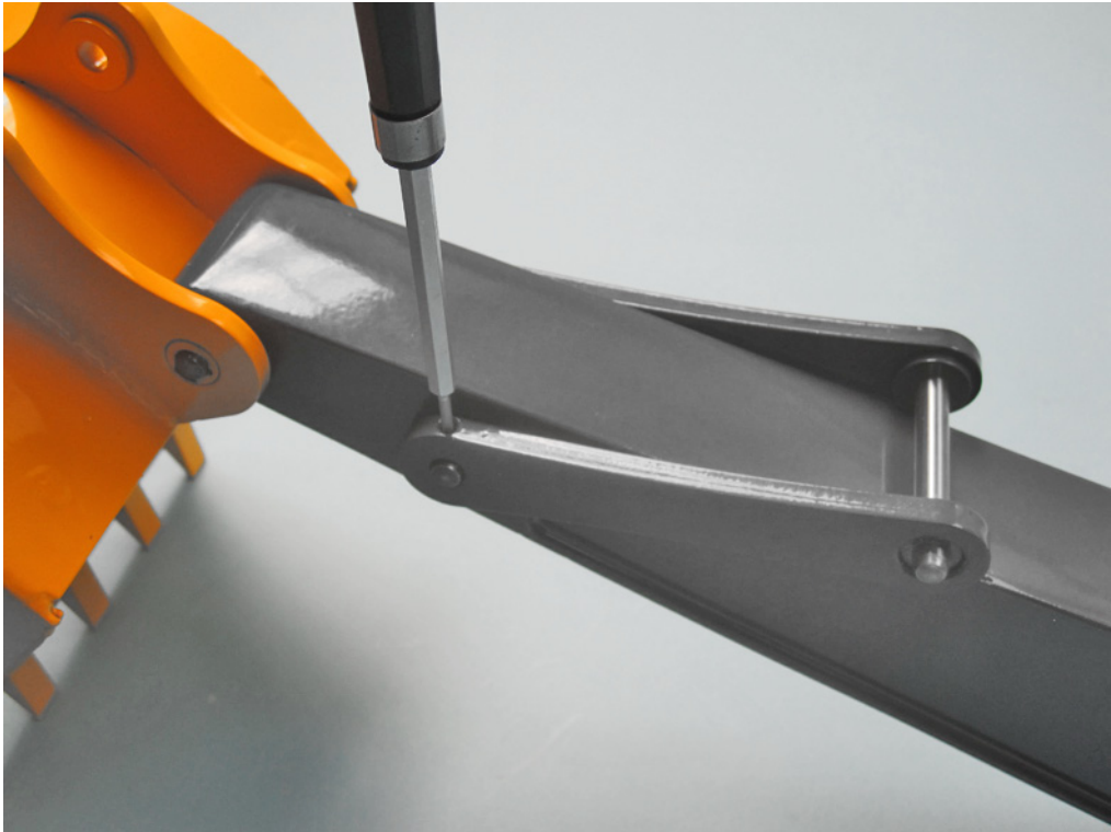
Mit Madenschrauben sichern
