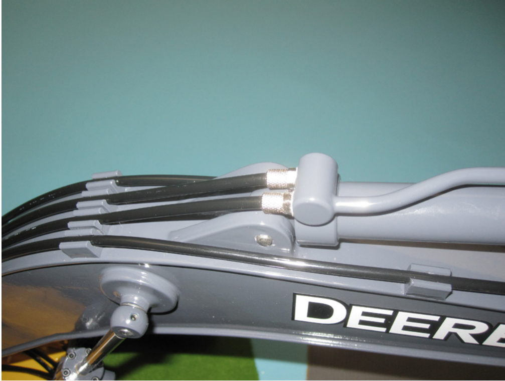
Wellenlagerung mit Verkleidung
