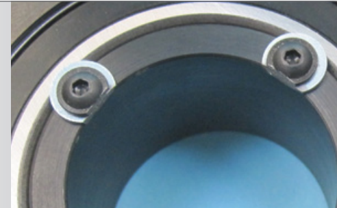
und U-Scheiben bündig abschleifen
